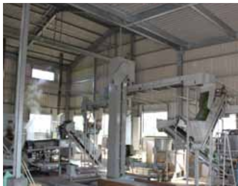
▲工場での一次加工の工程の一部。手前で茶葉についた火山灰や汚れを洗浄して、奥の機械で蒸しているところです。他に、6つの過程を経て「荒茶」が完成します。
