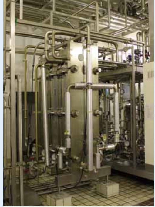
▲最新型のウルトラ殺菌機。ステンスプレートを利用した間接法による滅菌機。運ばれた生乳は、いくつものチェックを通り、ここで滅菌処理されます。
