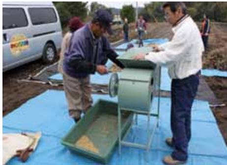
▲収穫した大豆を、中央の機械で風を送って、豆と殻を分けます。アナログですが優れモノです。
