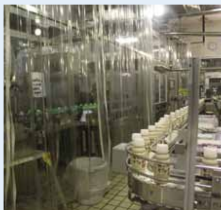
▲「高千穂牧場カフェ・オ・レ」の製造風景。左側のビニールの向こうで容器に詰められたものが、次々と右側のコンベヤで流れていきます。
