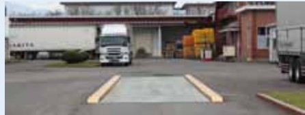
▲トラックスケール。生乳が入った状態で重さを量り、取り出した後、重さをはかって乳量を調べます。
