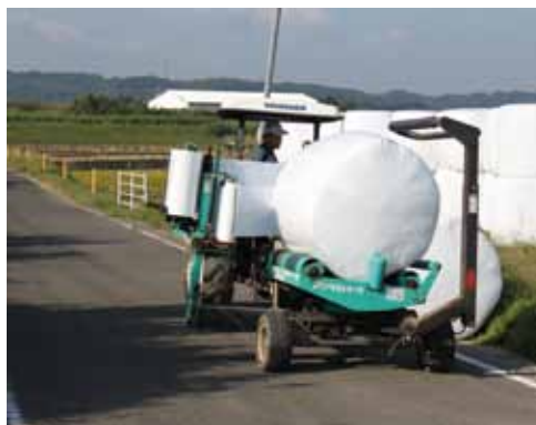
▲この塊の中に餌の牧草がつまっています。ミント色の機械が、包帯をぐるぐる巻くように回転して出来上がります。農業の機械は珍しいものばかりです。
