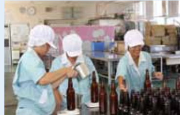
▲633ml以上になるように、計量しながら微調整。細かい作業の連続です(汗)
