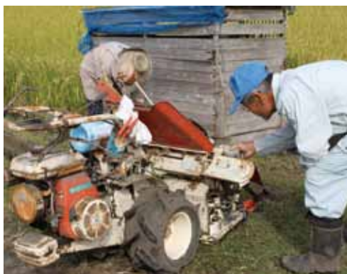
▲稲刈り前に、入念に機械をチェックします。この機械で刈りこみと束ねるが同時にできます。今ではもっと新しいものが出ていますが、それでも手作業に比べたら格段の違いですね。
