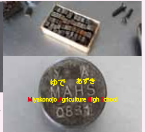
▲製造日印字用のパーツ(上)と凹凸板(下)。ピンセットではめ込みます。意外に大変です。
