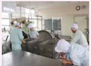
▲殺菌処理をするため高圧釜の中へ。生徒たちの作業はひとまず終了です。
