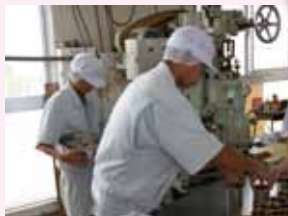
▲真空巻締機で一つ一つ蓋をしていきます。
